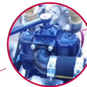
Masport-vacuümpompen, vermaard om hun stevigheid en hun vermogen om langdurig te werken zonder oververhitting.
